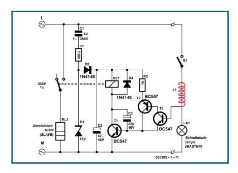
Die hier vorgestellte Lösung misst keinen fließenden Strom, sondern die am eingeschalteten Master anliegende (Wechsel-)Spannung. Als Master und gleichzeitig überdimensionale und kaum ignorierbare Kontroll-Anzeige wird hierzu eine gewöhnliche Schreibtischlampe missbraucht. Das elektrische Feld in der Zuleitung ist die steuernde Größe. Sie kann sehr einfach durch ein Stückchen
